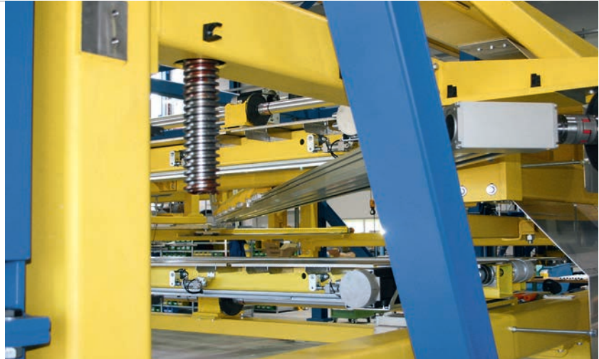
Un módulo lineal en tándem MDKUSE25-3ZR garantiza una manipulación precisa, de longitudinal a transversal, de las piezas de chapa de acero del transformador.
