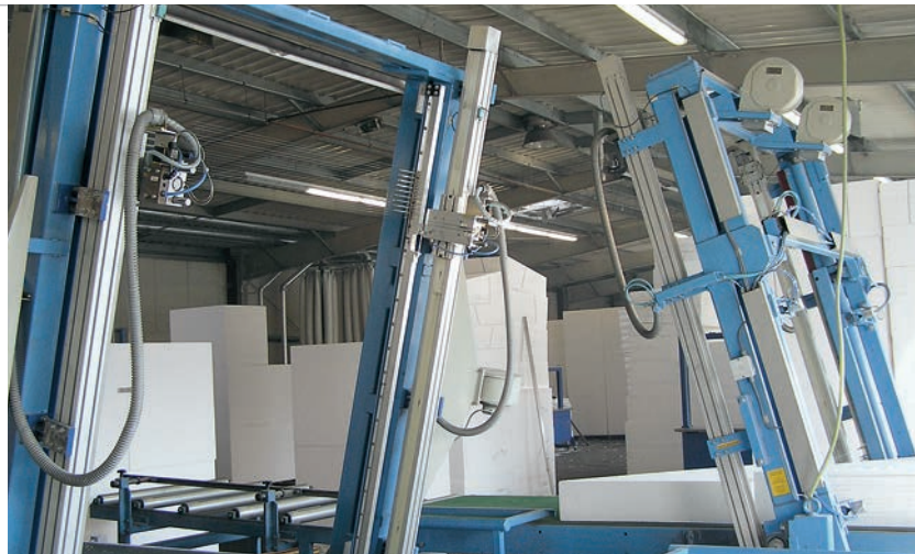
El caballete de corte está formado por dos módulos lineales INA MKUVE20-B-ZR, cada uno de los cuales está equipado con un sistema de pinzas y nueve unidades unipolares
